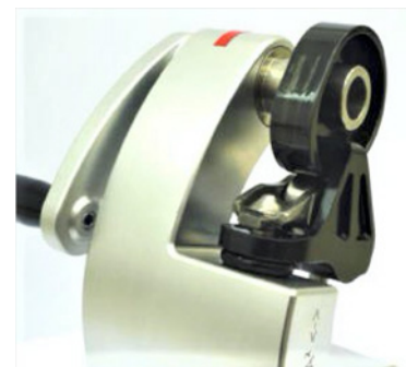
12-13 Model Desmotronic 5, met hydraulische klepspelingsinstelling.
