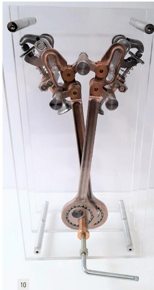
10 Vooraanzicht van het model met simpele aandrijving. In het model heb ik het krukastandwiel (15-tands) en het excenterstandwiel (30-tands) weggelaten. Het scheelt in bouwhoogte, bouwdiepte, arbeid, montageperikelen en vooral ook in de portemonnee.
