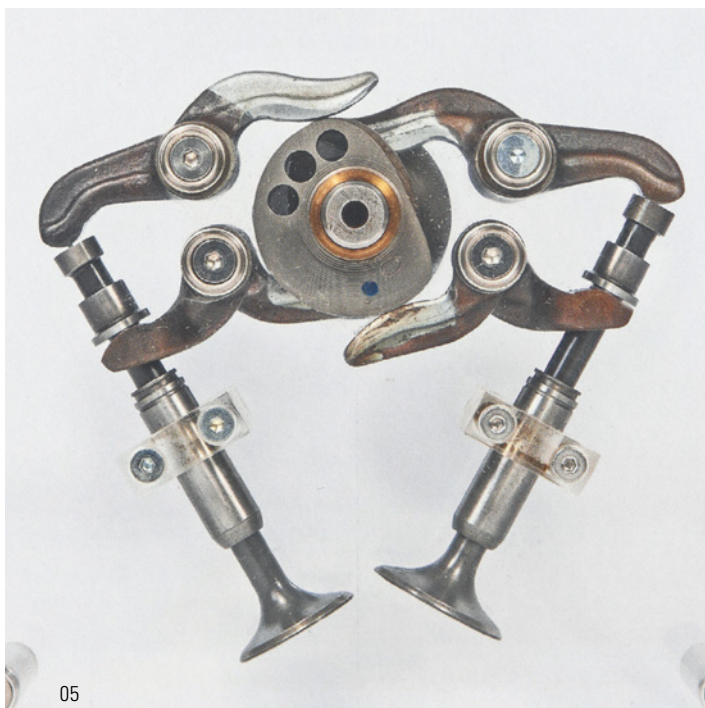
05 Model van Ducati Pantah (Groep 6A). Gezamenlijke nokkenas voor de in- en uitlaatklep, welke elk via twee tuimelaars wordt geopend en gesloten.
